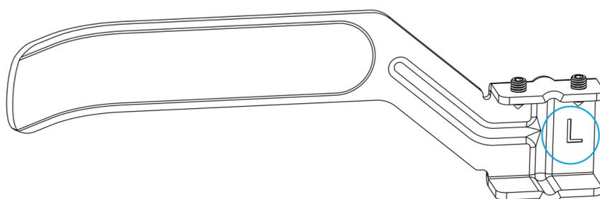
3. Fixe a chapa metálica do limite esquerdo ao suporte de engrenagens no lado esquerdo do abre-portas (segurando que a parte curvada da chapa metálica do limite se encontra acima do suporte de engrenagens).
