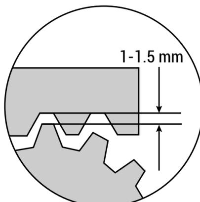
4. Utilize parafusos e pinças para fixar o suporte de engrenagens no centro dos orifícios oblongos (na linha de marcação), enquanto utiliza o mini nível fornecido para se certificar de que o suporte de engrenagens se encontra na posição horizontal.
