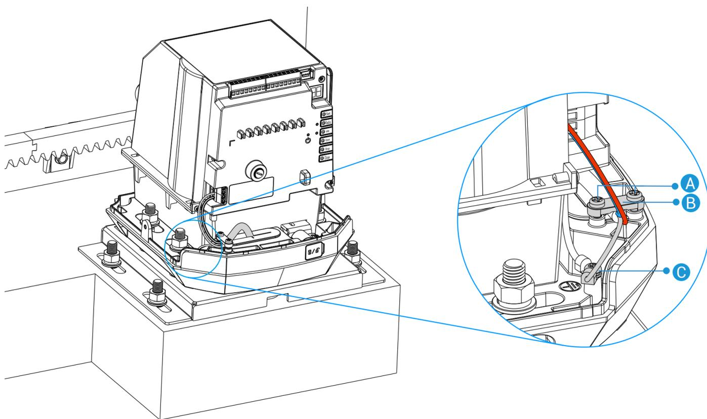
2. Ligue o fio vivo (fio vermelho na figura) à interface L e o fio neutro (fio azul na figura) à interface N (consulte o autocolante no abre-portas, conforme indicado abaixo).
