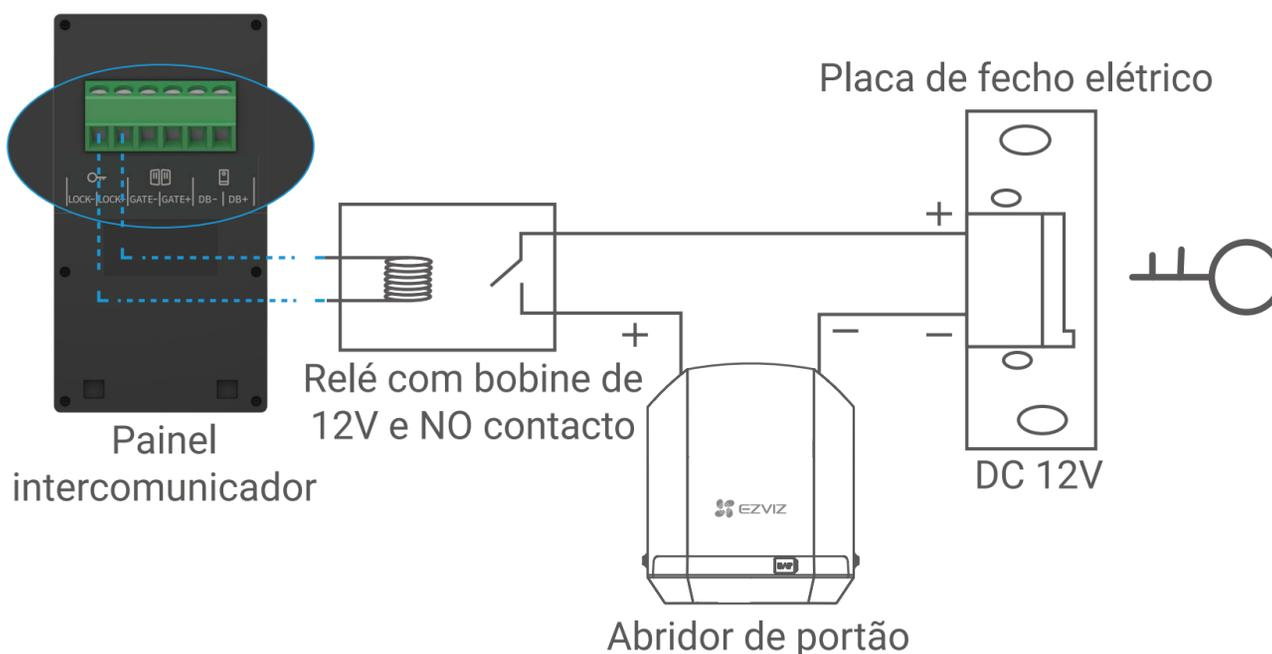
Ligue os fios da sua chapa de fecho elétrico aos terminais 5 e 6 ("LOCK") no abre-portas. Certifique-se de que liga o fio positivo ao terminal 6 e o fio negativo ao terminal 5.
