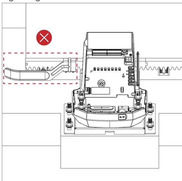
A parte de flexão da chapa metálica limite não está em contacto com a mola no abridor de portão.
