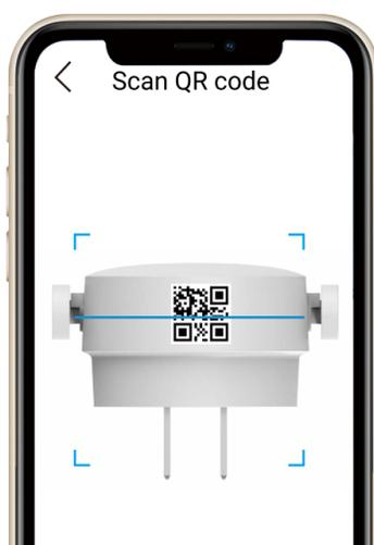
4. Siga o assistente da aplicação EZVIZ para concluir a configuração da rede Wi-Fi e adicionar o repetidor sem fios à sua conta EZVIZ.
