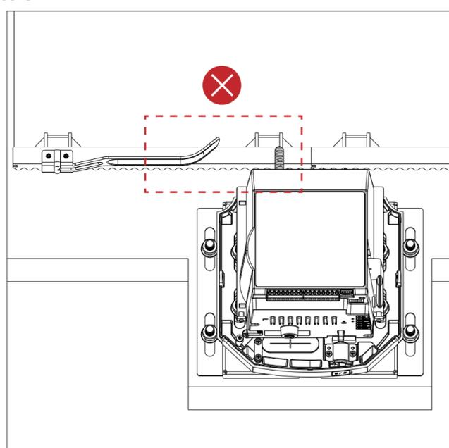
6. Deslize o portão para a extremidade esquerda e fixe a chapa metálica com a extremidade direita da mesma forma.
