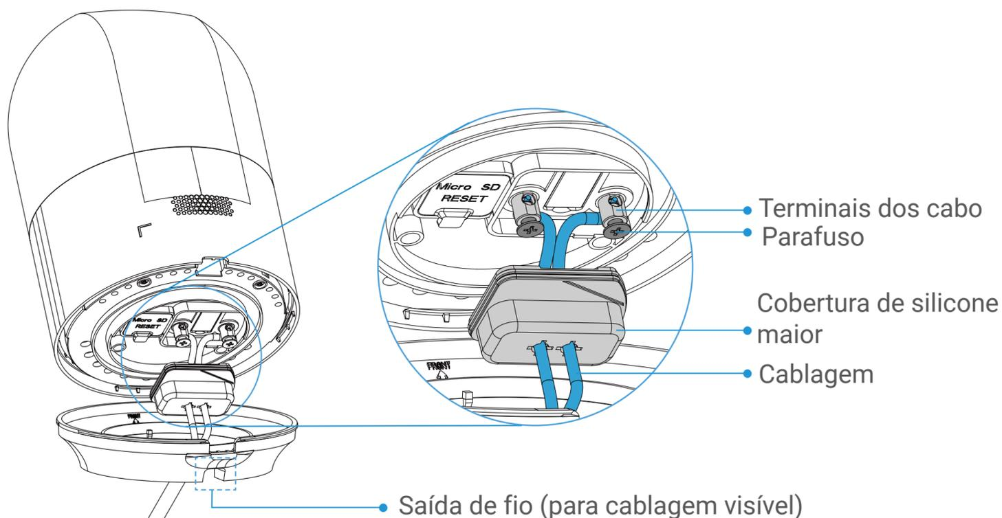
**i** Se estiver a utilizar cablagem visível, guie os fios através da tomada de fios após a ligação.
