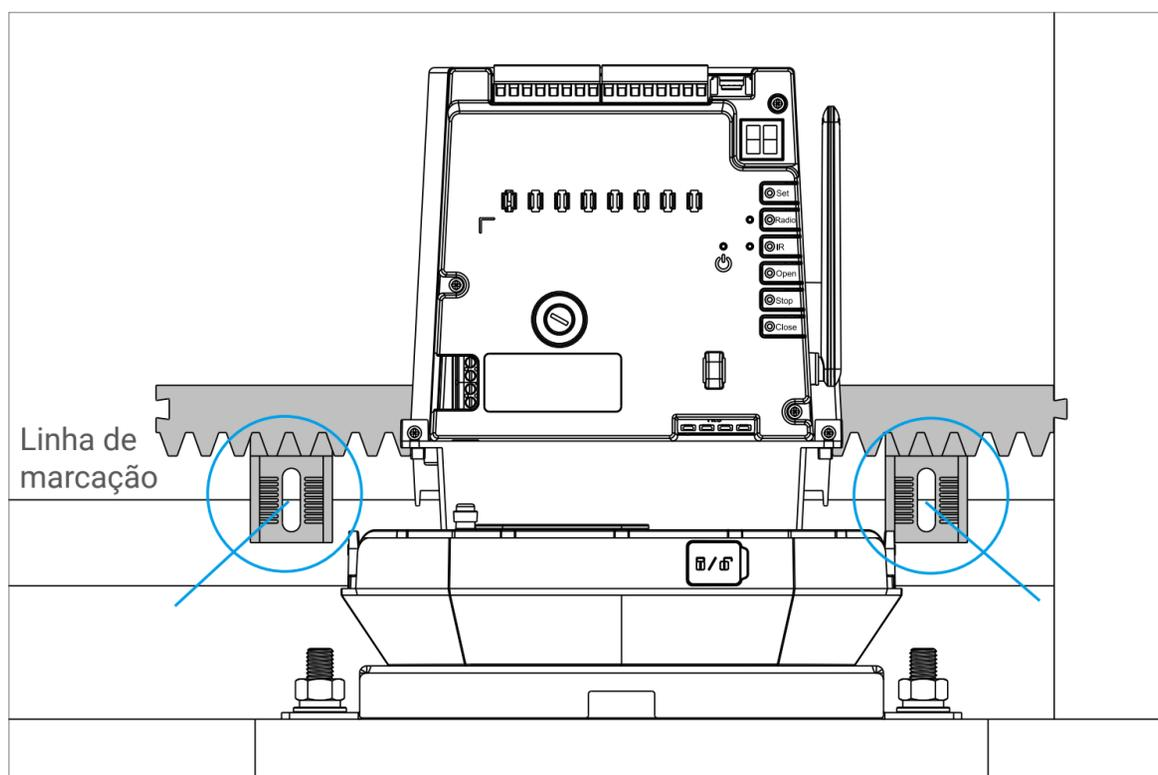
**i** Deixe uma distância de 1 a 1,5 mm entre a prateleira e a roda dentada do motor de engrenagem. Se a distância for demasiado grande após os esforços, considere adicionar uma placa de revestimento (com orifícios para os parafusos passarem através dela) entre o abre-portas e a base de montagem.
